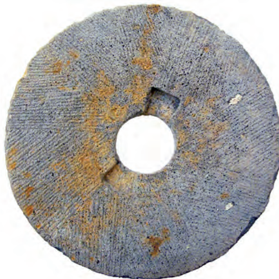
Afbeelding 1. Grote maalsteen, zij- en onderaanzicht van de werkende positie van deze lopersteen. Goed is de concave vorm van het maalvlak te zien, die moet aansluiten op het convexe maalvlak van de eronder te plaatsen (ontbrekende) liggersteen.
